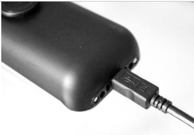
USB-Kabel an den USB-Anschluss des Telefons anschließen. Das andere Ende des USB-Kabels am Netzteil oder einem USB-Anschluss anschließen.
