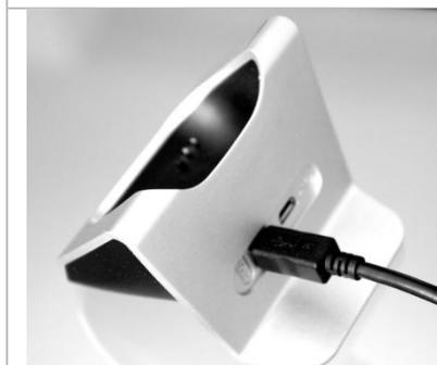
Über den USB-Anschluss für die Stromversorgung können Sie sowohl das Mobilteil als auch den Ersatzakku aufladen.
