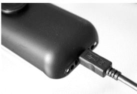
USB-Kabel an den USB-Anschluss des Telefons anschließen. Das andere Ende des USB-Kabels am Netzteil oder einem USB-Anschluss anschließen.
